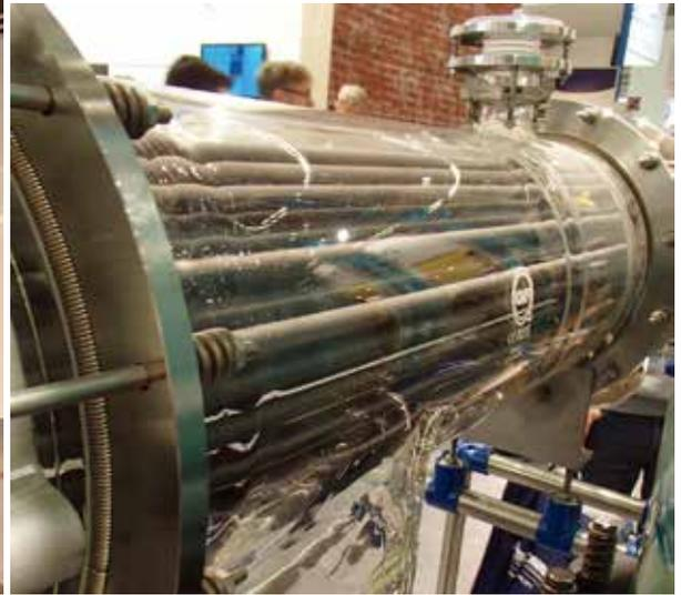
SiC多管式熱交換器
